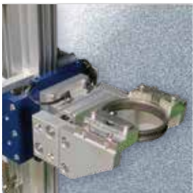
リング搬送例 外径チャック・固定搬送
