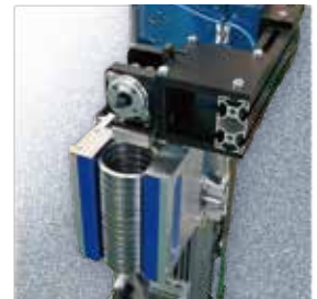
リング複数同時搬送例 外径チャック・ フローティングヘッド付(同一姿勢搬送) ※積込装置・バラシ装置等も対応可能
