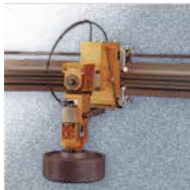
リング搬送例 内径チャック・フローティングヘッド付 (同一姿勢搬送)
