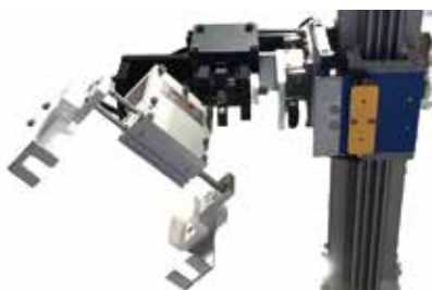
姿勢回転機構を搭載したチャック部事例
